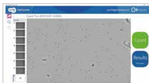
图4. 点击“Count”计数按钮，对样本进行计数。可进行8次计数，并同时上传云端分析数据。
